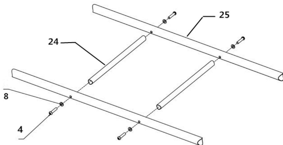
**PASUL 8:** Conectați barele folosind șuruburi (4) – 6 buc și (8) – 6 buc.
