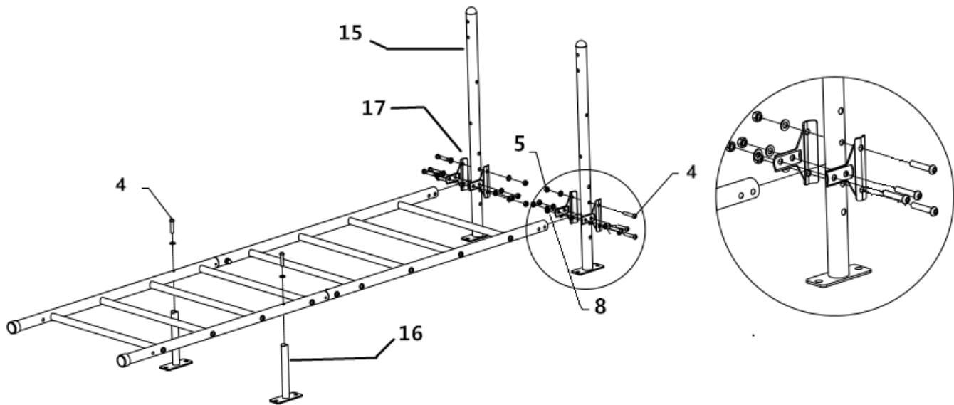
**KROK 4:** Spojte horizontálnu tyč (23) – 1 ks k setu, pomocou skrutiek (4) – 2ks a (8) – 2 ks.
