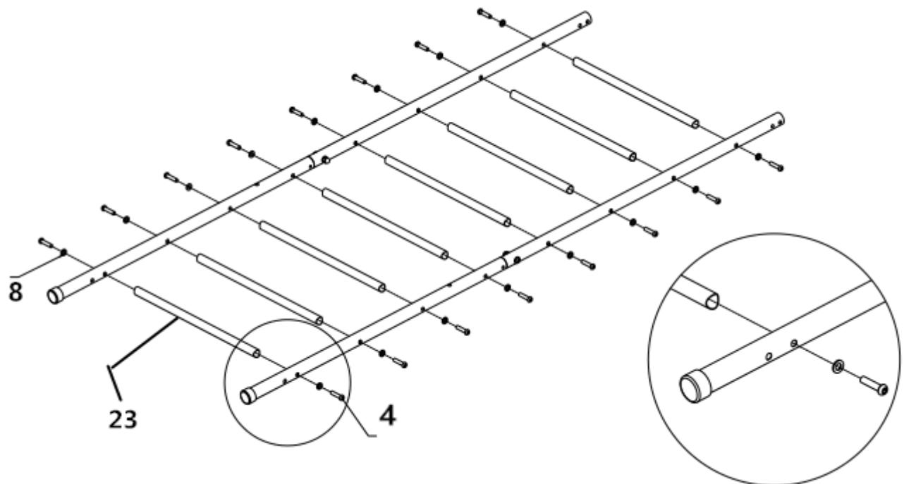
**PASUL 3:** Ataşați tijele (15) – 2 buc, (16) – 2 buc la șaiba T (17) – 4 buc, folosind șuruburi (4) – 10 buc, (8) – 10 buc și (5) – 8 buc.
