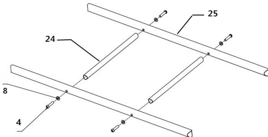
**KROK 8:** Spojte tyče pomocí šroubů (4) – 6 ks a (8) – 6 ks.
