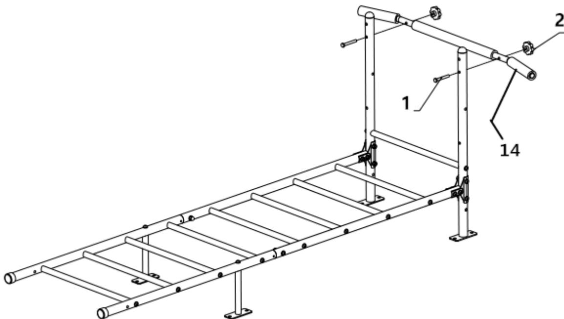
**PASUL 6:** Conectați tijele (19), (21), (15), (16) folosind șaiba (17) – 2 buc, șuruburi (6) – 1 buc, (8) – 7 buc, (5) – 4 buc, (4) – 5 buc și (3) – 1 buc.
