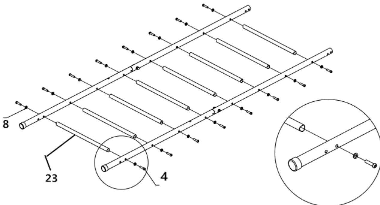
**KROK 3:** Pripevnite tyče (15) – 2ks, (16) – 2 ks k T podložke (17) – 4 ks, použite skrutky (4) – 10 ks, (8) – 10 ks a (5) – 8 ks.
